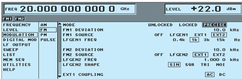
Das FM-Modulationsmenü zeigt beispielhaft die übersichtliche Darstellung aller Einstellmöglichkeiten und des aktuellen Gerätestatus; mit dem Drehknopf und wenigen Tasten lässt sich die Einstellung in Sekundenschnelle vornehmen
