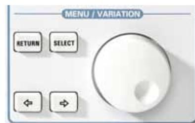
Bild 10: Generelle Einstellungen und Menüauswahl mit Drehknopf, Return, Select und Pfeiltasten
